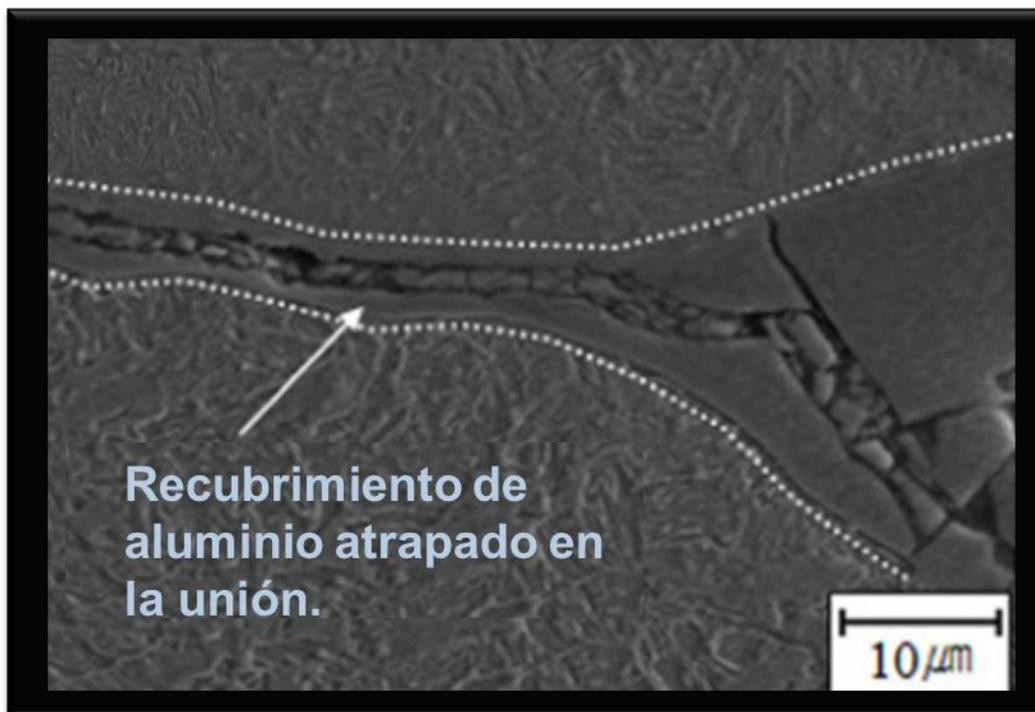
**Figura 2.37** Imagen obtenida por medio de microscopia electrónica de barrido representativa de una unión en la cual se aprecia como la fase de aluminio queda atrapada como un residuo afectando la coalescencia de los metales base. (42)
