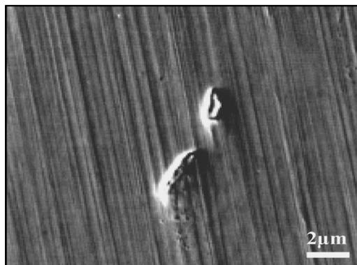
**Figura 2.12** Imagen obtenida por la técnica de análisis EPMA por sus siglas en inglés de los precipitados de boro  $\text{Fe}_{23}(\text{CB})_6$ , obtenidos por la alta temperatura
