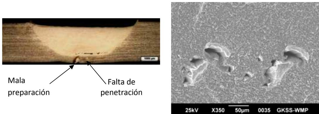
**Figura 9.** Apariencia a altas magnificaciones de la presencia periódica de los defectos que se observan en la macrografía de la unión FSW\_160709-06.
