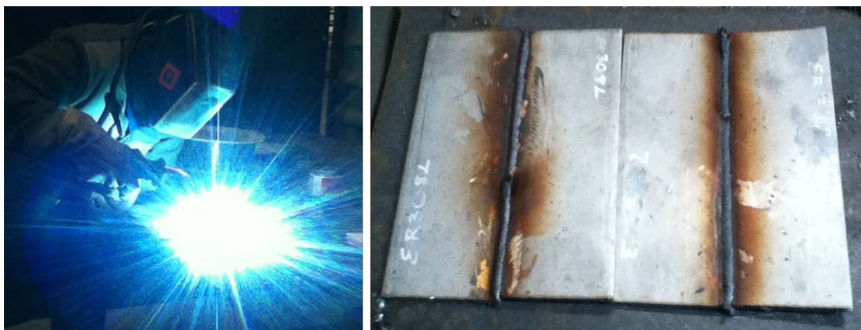
Figura 3.1 Vista general de los cupones de soldadura, electrodos ER308L y ER312.
