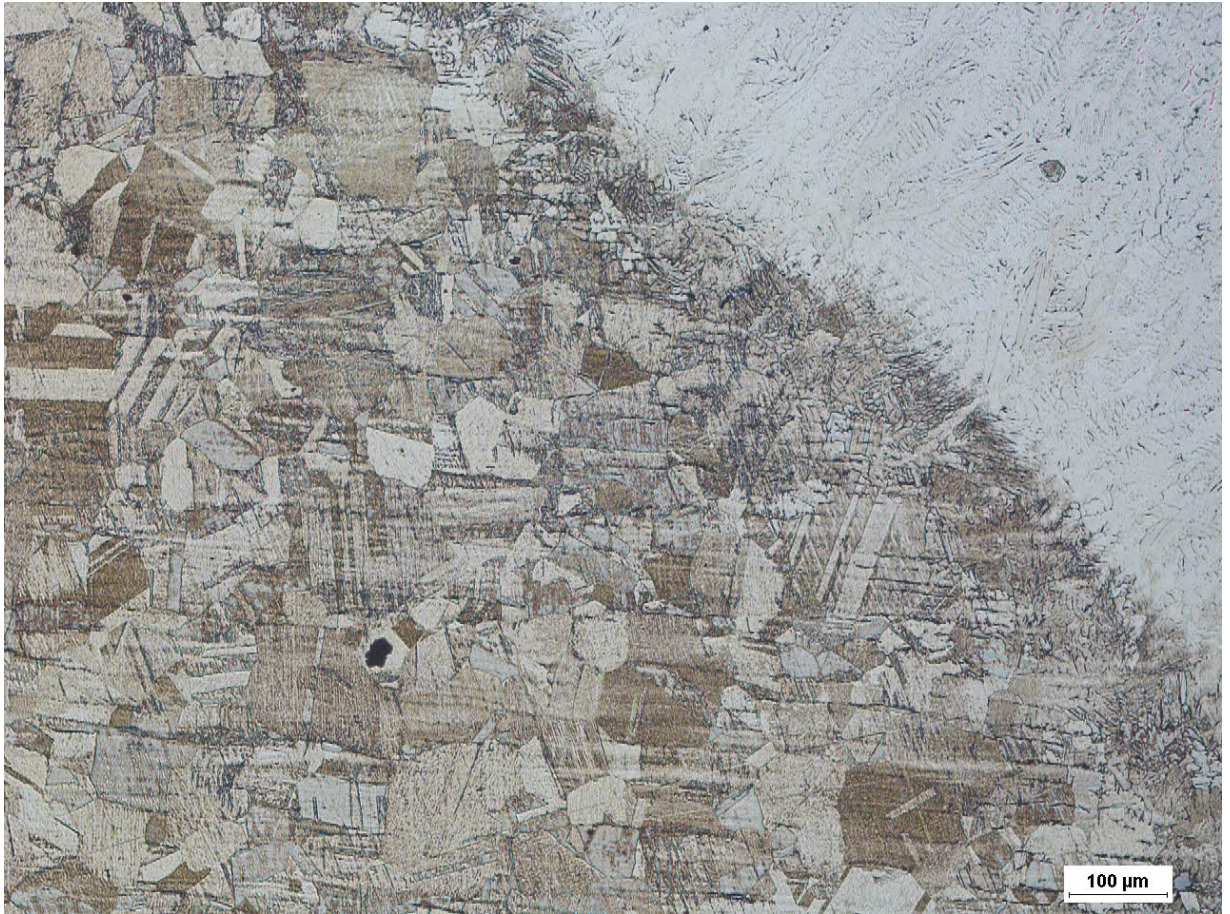
Figura 4.12 Transición del metal base a la zona de fusión de la soldadura en la unión de la placa de Acero 304L.
