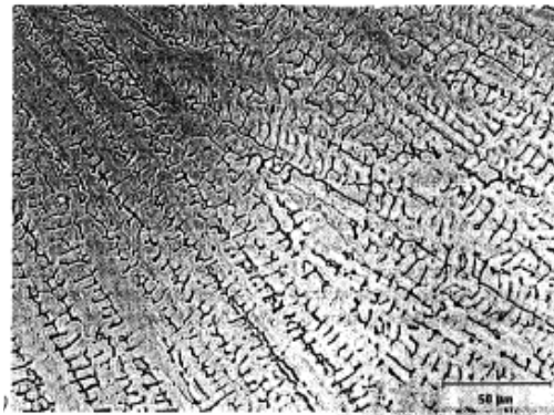
Figura 2.6 Micrografía de la microestructura resultante de la solidificación tipo FA Ferrita esqueleto (7).
