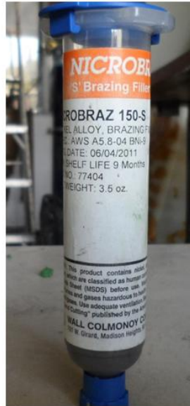
Figura 4.1 Pasta Nicrobraz BNI-9 para soldar álabes de turbina base níquel por Brazing en horno de resistencias.
