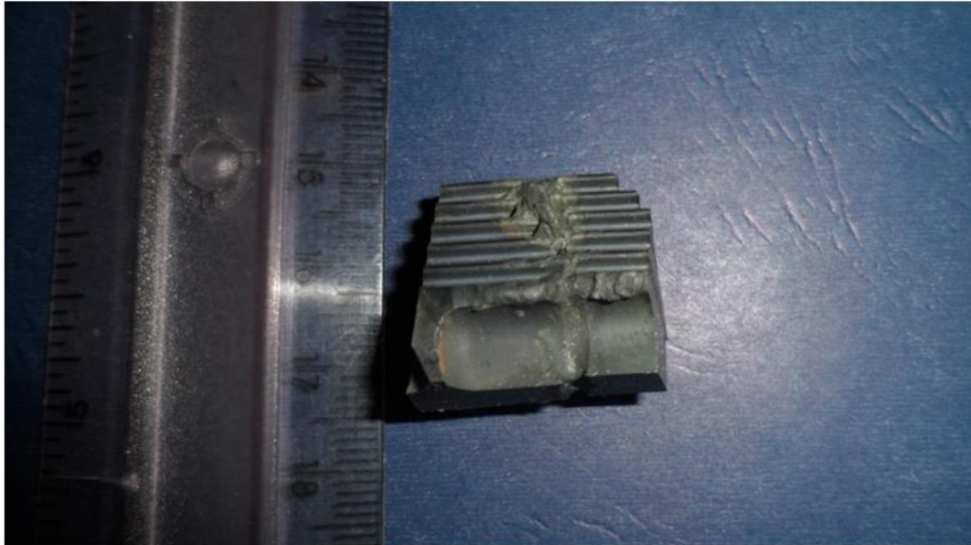
Figura 4.9 Muestra de un álabe unido por el proceso brazing en horno de resistencias.
