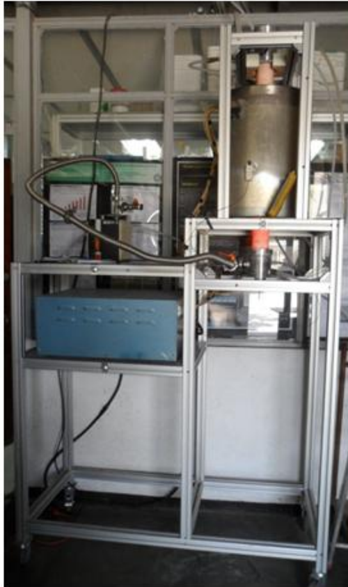
Figura 4.3 Ilustración del acondicionamiento del horno de resistencias para aplicar el proceso Brazing.
