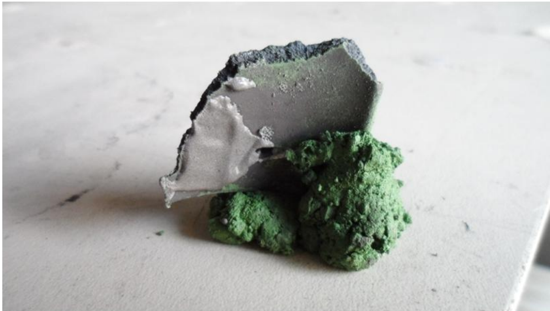
Figura 4.2 Álabe unido con pasta colocada sobre barro refractario plástico antes de aplicar el proceso brazing en horno de resistencias.
