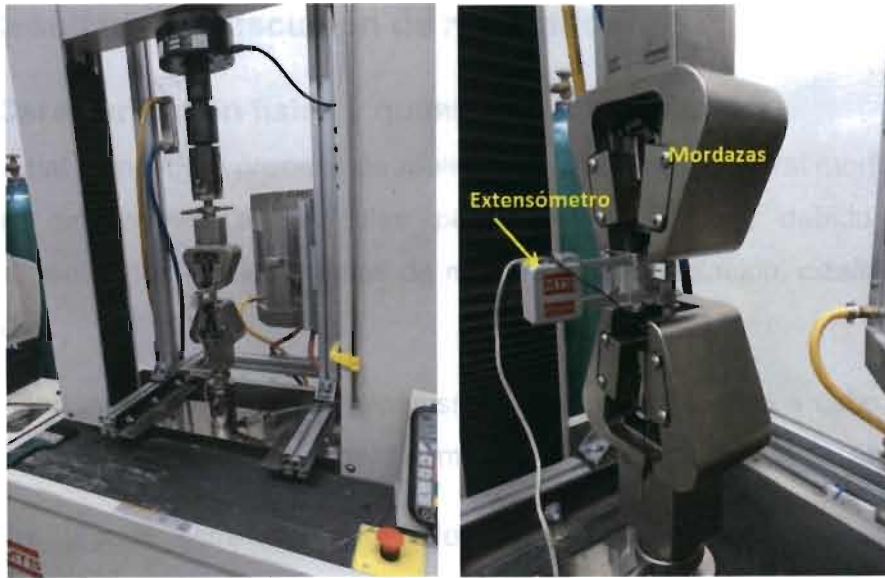
Figura 26. Máquina de ensayos universales utilizada para ensayos de tensión.
