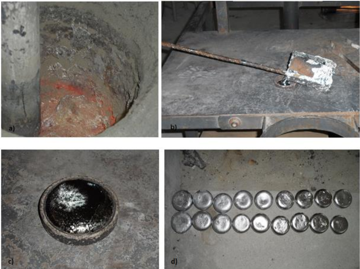
Figura 7-5. Fusión y vaciado de la aleación Al – Si A380 con la mezcla de arena sílice y nanopartículas de \text{SiO}_2 . En a) fusión de la aleación e inyección de la mezcla, b) Vaciado de una probeta durante la fusión, c) Muestra vaciada de la aleación y, d) Probetas solidificadas vaciadas cada 10 minutos durante la inyección.
