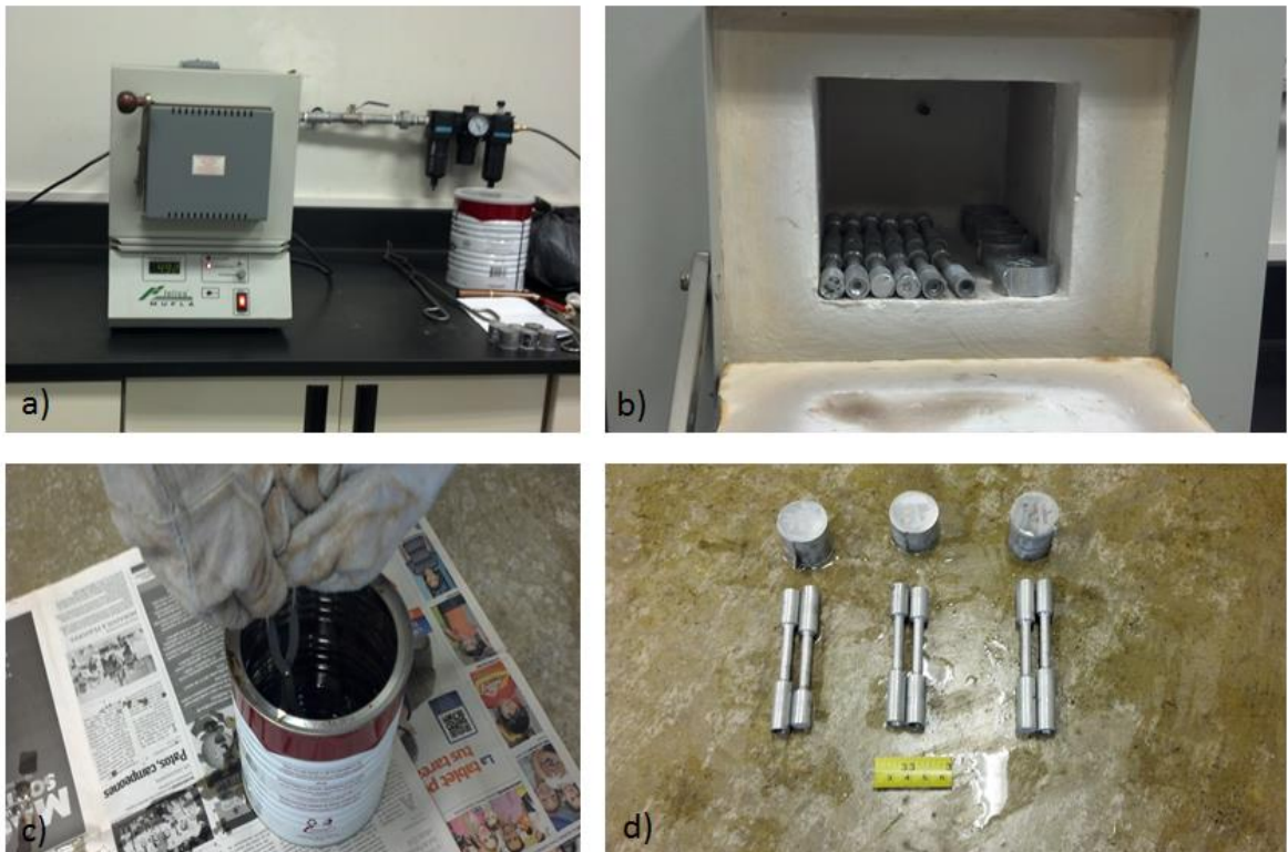
Figura 7-10. Tratamiento térmico de solubilización y envejecido. a) Calentamiento del horno mufla a la temperatura de solubilización, b) Colocación de las probetas para el tratamiento, c) Temple en aceite de las probetas después del envejecido y, d) Vista final de las probetas después del tratamiento térmico.
