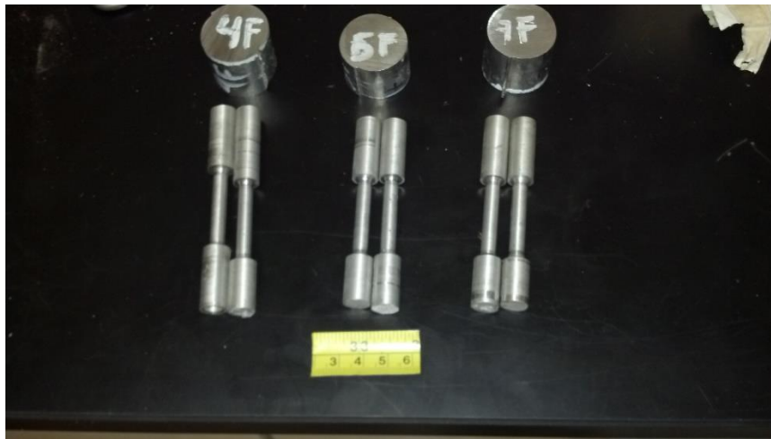
Figura 7-9. Probetas para el ensayo de tensión y dureza de la aleación A380.
