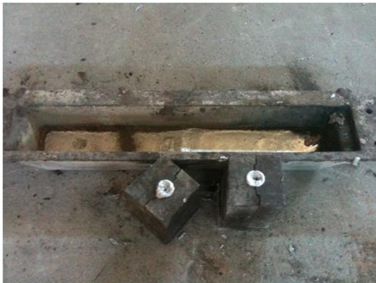
Figura 7-6. Aluminio A332 vaciado en los moldes de las probetas de tensión.
