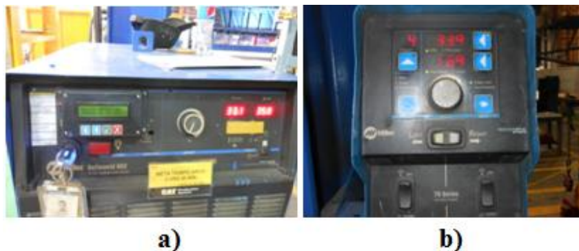
Figura 3.9 Equipo de soldar a) Miller Deltaweld 652 b) alimentador de electrodo Miller
