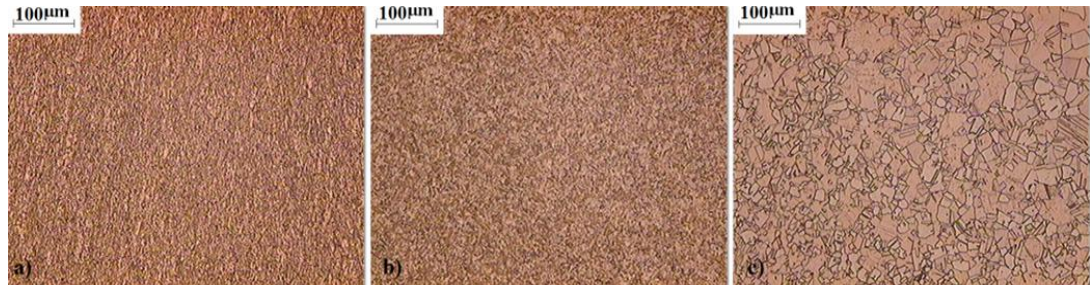
Figura 4.8 Crecimiento de grano a 100x, a) 0 min, b) 300 min, c) 600 min
