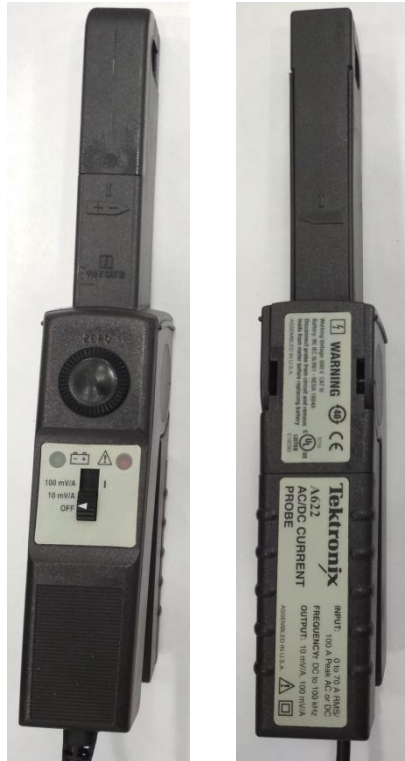
Figura 6.5: Sonda de corriente Tektronix A622 (elaboración propia).
