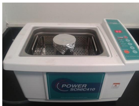
Figura 4.4 Mezcla del aporte con nanopartículas de WC en el ultrasonido.
