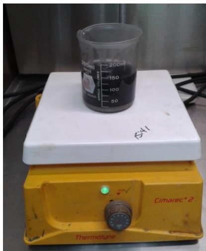
Figura 4.3 Mezcla del aporte con nanopartículas de WC en la parrilla de agitación.
