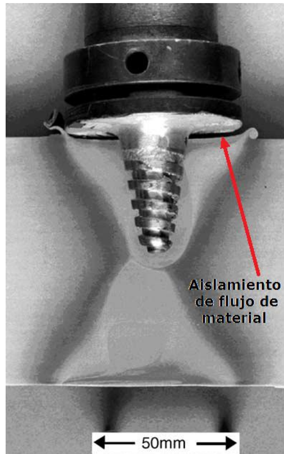
Fig. 2.10. Esquema representativo de la acción del pin y del hombro que también proporciona aislamiento para el volumen de material que fluye durante el proceso [31].
