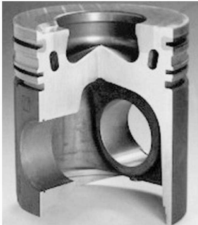
Fig. 2.1. Pistón para motor diesel hecho de aluminio reforzado con fibras cortas de \text{Al}_2\text{O}_3 [10].
