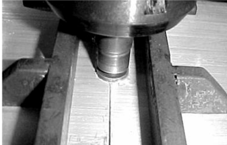
Fig. 2.12. Cuerpo, hombro de la herramienta, y soportes sujetadores [14].
