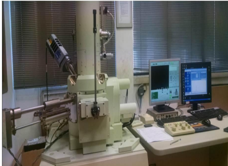
Figura 4. 24 Microscopio electrónico de barrido conectado al monitor con su respectivo software.
