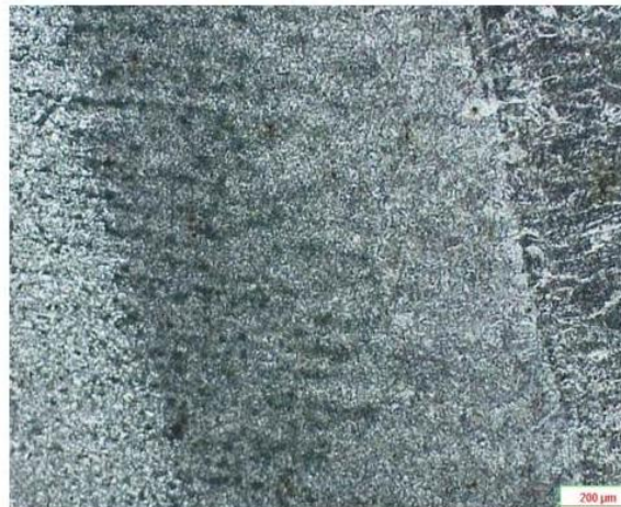
Figura 4. 13 Fotomicrografía en escala de 200 µm presentando 3 zonas, de izquierda a derecha: metal base, ZAC, y metal de soldadura.
